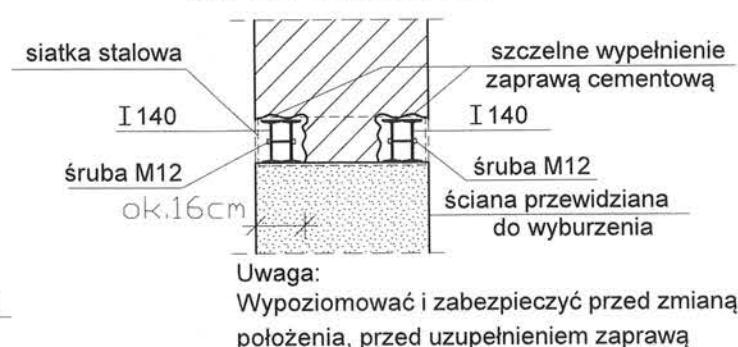
SCHEMAT WYKONANIA NADPROŻA
